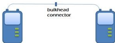
Abbildung 105: Die Testsets sollten vor Beginn der Messung abgeglichen werden
