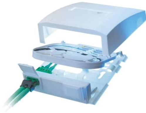
Abbildung 43: Detailansicht einer OTO: Spleißkassette, Biegeradiusführung, Frontplatte mit Ausschnitt für LC Kupplung
