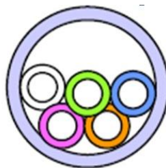
Abbildung 59: Nachträglich installierte Mikro-Rohre
