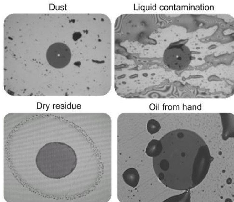
Abbildung 101: Erscheinungsbild verschiedener Verschmutzungen auf der Steckverbinderstirnfläche
