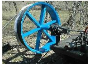
Abbildung 54: Schäkkel für Kabeleinzug Abbildung 55: Kabelführungsrolle
