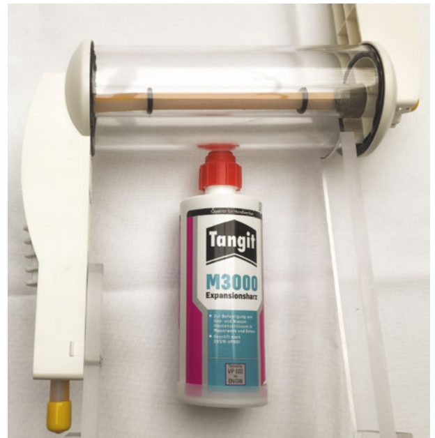
Abbildung 25: Beispielhafte Abdichtung einer Einspartenhaus-einführung mit Expansionsharz Quelle: ANGA Der Breitbandverband e. V.
