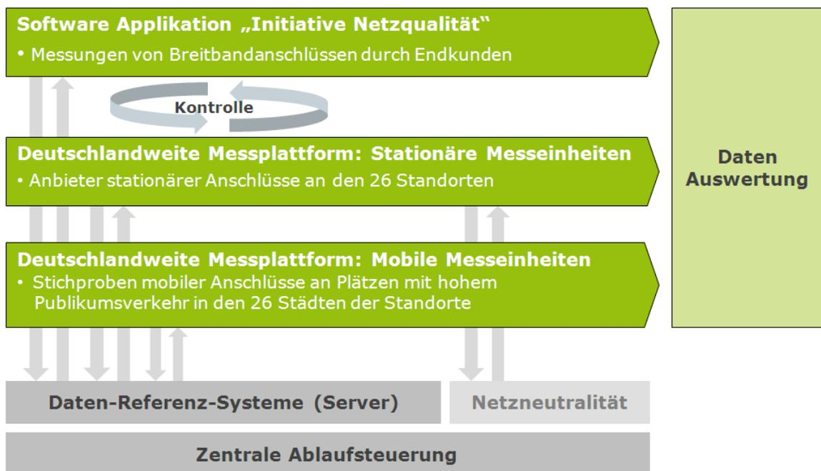
Abbildung 1.1: Integriertes Messkonzept
