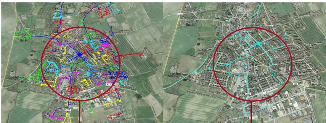
FTTB-Verteilernetz ◀ Die Unterschiede sind gering ▶ FTTC-Verteilernetz
