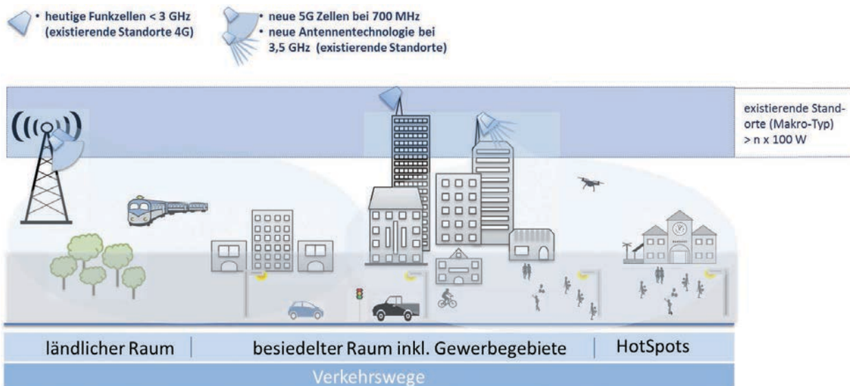
Abbildung 3: Schematische Darstellung einer ersten 5G Ausbaustufe auf existierenden Standorten Quelle: BMVI
