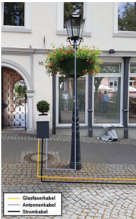
Abbildung 10: Small Cell Anbindung (schematisch) Quelle: Deutsche Telekom/Raycap
