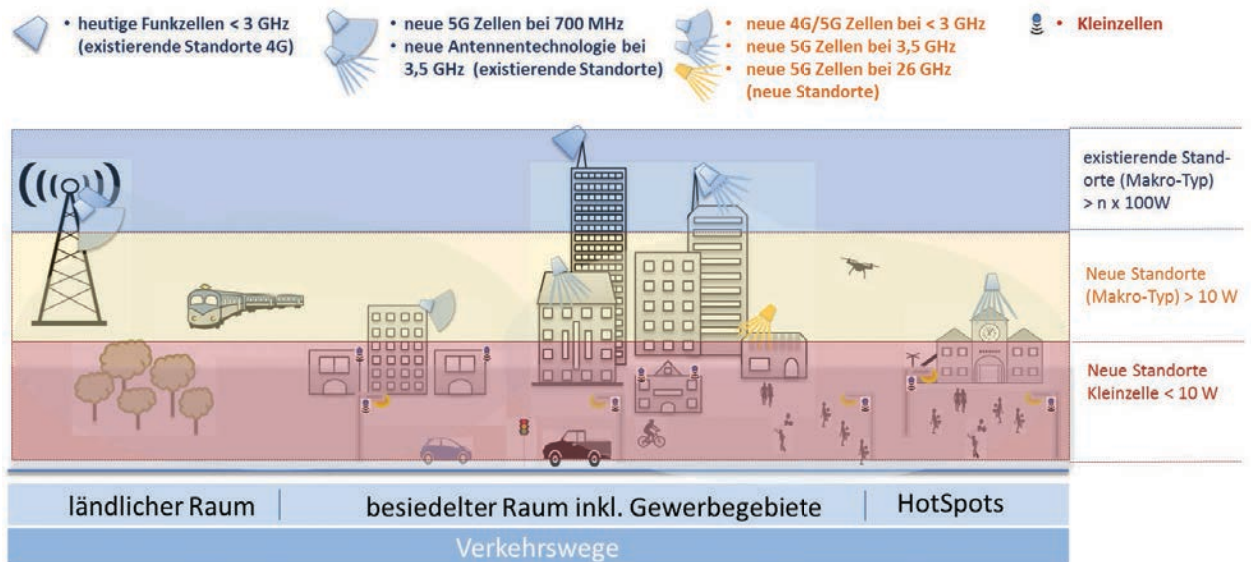
Abbildung 6: Vollständige Übersicht an Standort-Typen für die zukünftige 5G Netze Quelle: BMVI
